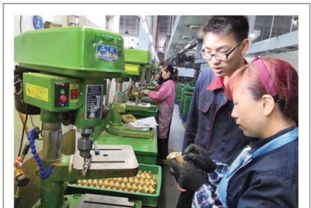
近日,诸暨工业职业技术学校农业机械使用与维护专业学生深入生产一线拜师学艺。在接下来的时间里,学生将在师傅带领下进行钻铣、毛坯检验、压蜡制壳、注塑、数控车床等操作。图为学生在师傅指导下进行纺织机配件刀身壳体的打孔倒角攻丝实训。
