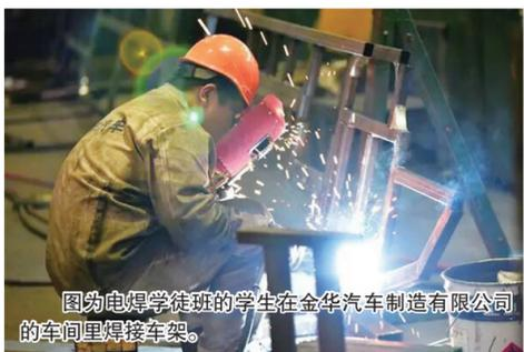
图为电焊学徒班的学生在金华汽车制造有限公司的车间里焊接车架。
